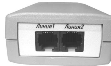
Рис. Вид спереди, входные розетки RJ11 – 2шт.
