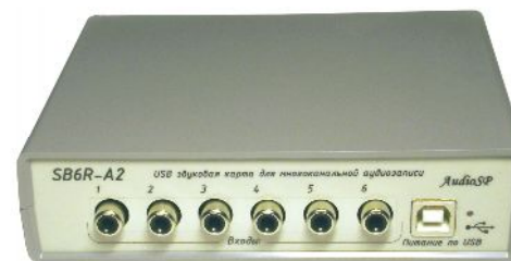
Рис. Вид спереди, входные разъемы RCA(f) – 6шт., выходная розетка USB BF.
